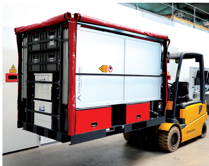
Die mobile Station ist speziell für den Transport auf der Straße, Schiene und als Luftfracht optimiert, wodurch eine reibungslose Logistik gewährleistet ist.
